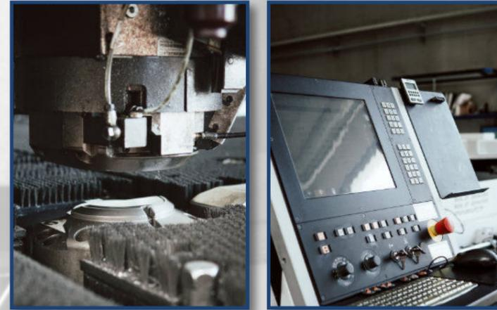
Ob Lasern, Stanzen oder Umformen - unsere Laser-Stanz-Kombi sorgt für exzellente Ergebnisse und das in nur wenigen Minuten. Die automatische Blechzufuhr und Teileentnahme sorgen für beschleunigte Prozesse.
