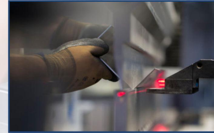
Unser umfangreiches Werkzeugsortiment ermöglicht die Fertigung vieler Kantformen. CNC-gesteuert kanten wir Blechzuschnitte ab - egal ob Kleinteil oder langes Bauteil. Wir realisieren alle Formen, ob gebogen, gerundet, geprägt oder gesteppt, vom spitzen Winkel, über kurze Schenkel bis zum exakten Radius und wählen die optimale Presse für Ihr Bauteil aus.
