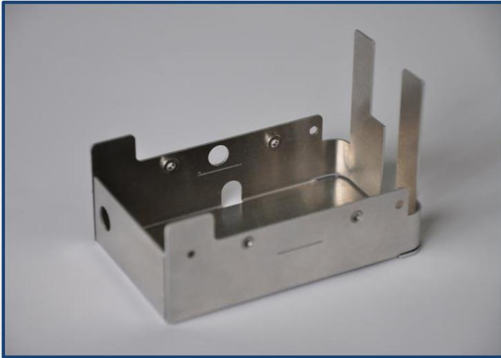
CNC-gesteuertes Abkanten von Blechzuschnitten, egal ob Kleinteil oder langes Bauteil.
