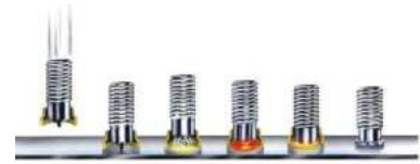
Abb. 27: Schweißbolzen Schweißprozess (Construction, 2022)
