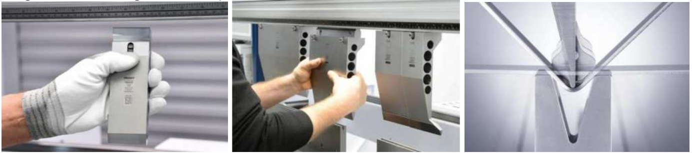
Abb. 15: Standardwerkzeug, Leichtbauwerkzeug und Sensorwerkzeug (Trumpf, 2022)( https://www.trumpf.com/de_DE/produkte/maschinen-systeme/biegemaschinen/trubend-serie-5000/ )
