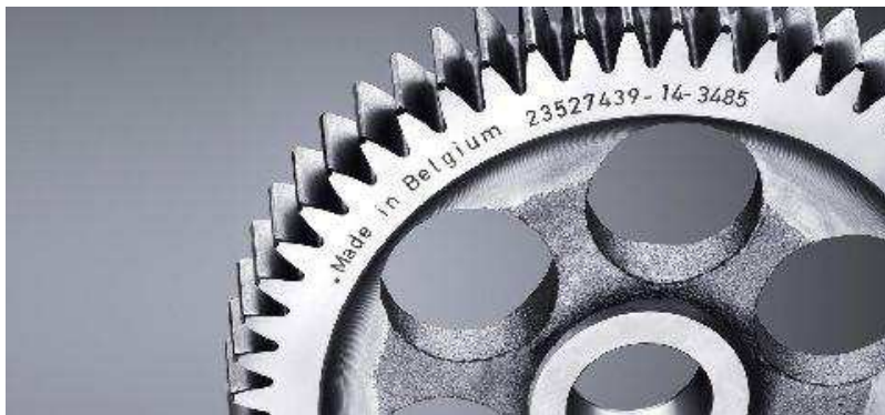
Abb. 12: Zahnrad mit Lasergravur (Trumpf, 2022)
