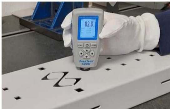
Abb. 35.1 und 35.2: Schichtdickenmessung Zelenka (Futronika, 2022)
